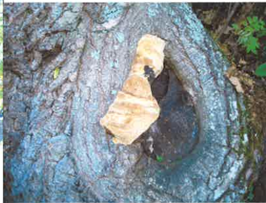
Angrepp av skadesvampen Korkmussling.
